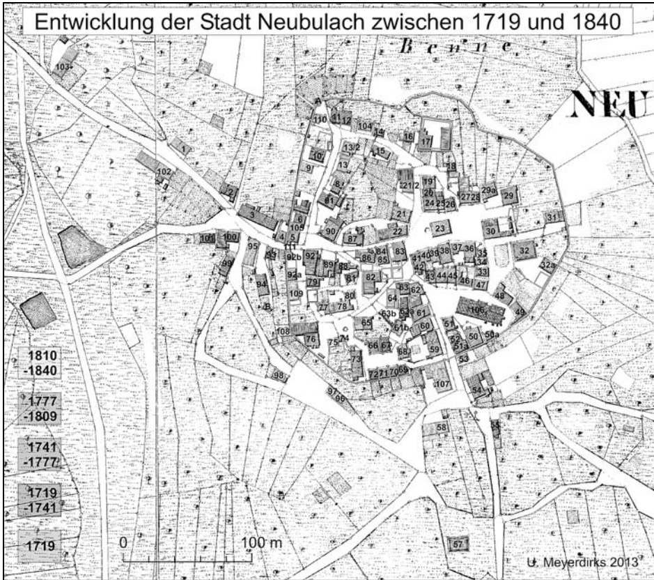
Abb. 4: Die 1836 aufgenommene und 1840 rektifizierte Flurkarte 1: 2500 enthält den ersten genau vermessenen Plan der Stadt Neubulach. Die blau unterlegten Gebäude sind bereits in der Bergwerkskarte von 1719 zu erkennen, die anderen Farben kennzeichnen die bis 1840 hinzugekommenen Gebäude. Zwischenzeitlich abgebrochene oder abgebrannte Gebäude sind als farbiger Umriss dargestellt. Die Hausnummern wurden spätestens 1823 eingeführt und blieben bis 1949 in Gebrauch, als die heutigen Straßennamen und die straßenweise Nummerierung eingeführt wurden Kartengrundlage: Flurkarte des Königreichs Württemberg 1: 2500, Blätter NW XIV-23 u. NW XIV-24
