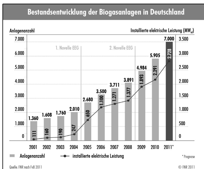
Abb. 2: Entwicklung der Biogasanlagen und ihrer installierten Leistungen in Deutschland. Deutlich wird die Korrelation mit den Anreizwirkungen durch das EEG und dessen Novellierung. Die Prognose für die Jahre 2010 und 2011 wurden jeweils sogar deutlich übertroffen, denn prognostiziert für 2010 waren rund 5.500 Anlagen und für 2011 6.000 Anlagen, Stand Ende 2011 waren es dann rund 7.000 Anlagen Quelle FNR 2012
